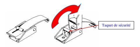
Il est conseillé de laisser la grenouillère fermée taquet de sécurité enclenché, pour emboîter les éléments, de manière à ce que le bras ressort soit maintenu écarté.
