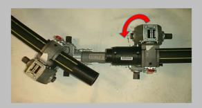
Ne jamais ramener simultanément les deux tubes ensemble dans le plan horizontal sous peine d'un glissement intempestif du positionneur qui peut être dangereux pour l'opérateur.
