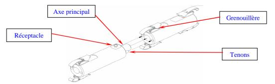
Ouverture de la grenouillère : il faut appuyer sur le taquet de sécurité quand on ouvre la grenouillère.
